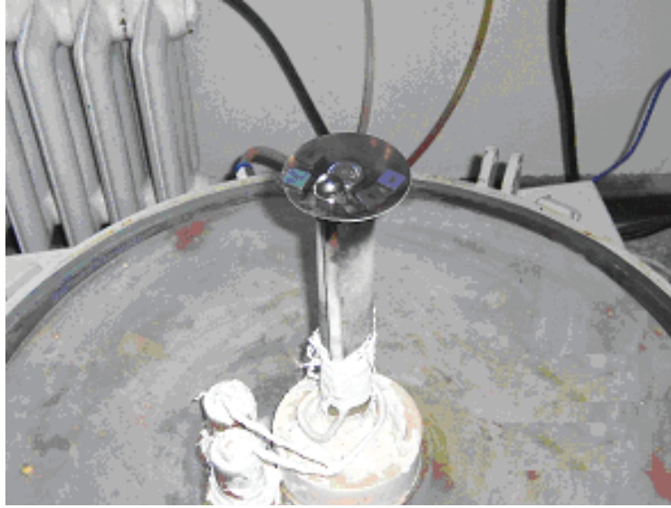
Şekil 4. Kesici uçların deney odasına yerleştirilmesi
