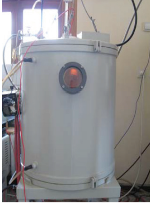
Şekil 2. Plazma borlama deney odası
