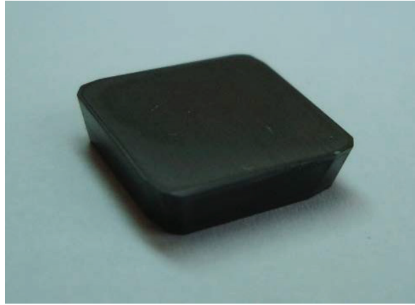
Şekil 6. Borlanmış kesici uç (Deney No:7-5-2)
